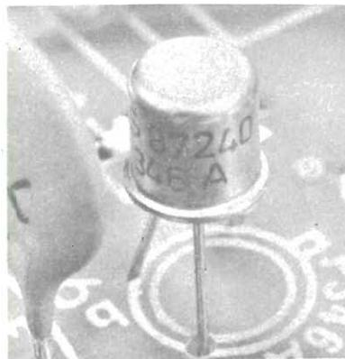
caso che variando il carico resistivo costituito da R1 non si rilevino cambiamenti della luminosità, il collettore e l'emettitore sono in corto circuito.
